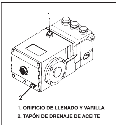
Ilustración #17 Drenaje De Aceite De La Bomba
