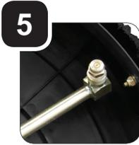
**5** Retourner le couvercle et vérifier que les embouts de gicleurs sont bien serrés et que le motif de pulvérisation est en ligne avec le bras rotatif.
