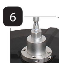
La fábrica preajuste la altura de su cabeza rotatorio de la tierra basada en el rendimiento máximo. Si decide subir o bajar la altura de la cabeza, afloje el perno de tensión en el cuello.
