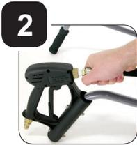
**2** Ensuite, serrer le bout tuyau "fixe" sur le pistolet qui est monté sur la portion supérieure du manche. Utiliser du ruban en téflon sur les bouts du tuyau et bien serrer avec une clé. Ne pas trop serrer.
