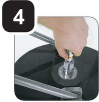
A continuar, apriete el extremo giratorio de la manguera con una llave en la parte superior de la cabeza rotatorio hasta que estén ajustados.
