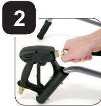
A continuar, apriete el extremo "fijado" de la manguera en el arma montado sobre la parte superior del mango. Utilice la cinta de teflón en los extremos de manguera y apriete con una llave hasta que estén ajustados. No apriete demasiado.
