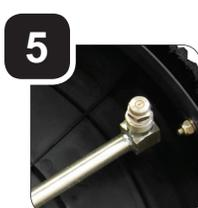
Gire la cubierta y asegure que las puntas de boquilla estén bien apretados y que el patrón de pulverización está en línea con el brazo rotatorio.
