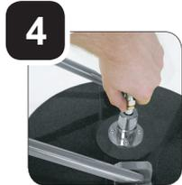
**4** Après, placer le côté pivotant du tuyau dans le haut de la tête rotative et bien serrer avec la clé.
